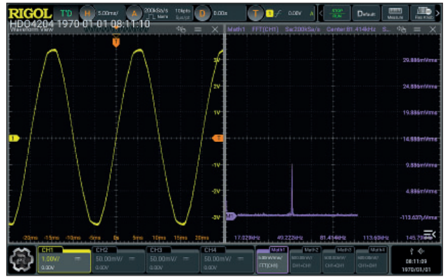
Рис. 4. Осциллограмма и спектральный состав напряжения в сети при включенном передатчике Fig. 4. Oscillogram and spectral composition of voltage in the grid with the transmitter on
