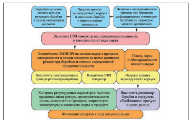
Рис. 2. Операционно-технологическая схема термообработки мясного сырья в установке с цилиндрическим резонатором-барабаном для работы в периодическом режиме
