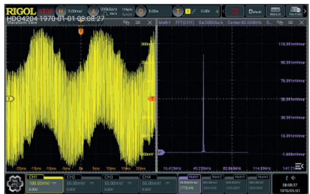
Рис. 5. Осциллограмма и спектральный состав напряжения на выходе резонансного контура L2C4 Fig. 5. Oscillogram and spectral composition of voltage at the output of the resonant circuit L2C4
