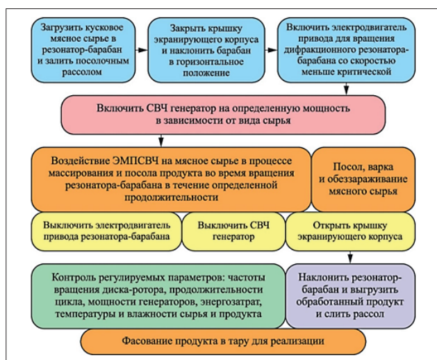
Рис. 3. Операционно-технологическая схема термообработки мясного сырья в установке с цилиндрическим резонатором-барабаном для работы в периодическом режиме
